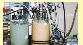
水素酸化細菌の水素と炭酸ガスを培養基質とした増殖の様子
